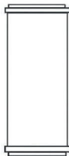
Filterhus med åpning i begge ender (DOE)
